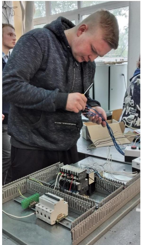
3. Коммутация распределительных коробок и сборка схемы освещения по заданию.
